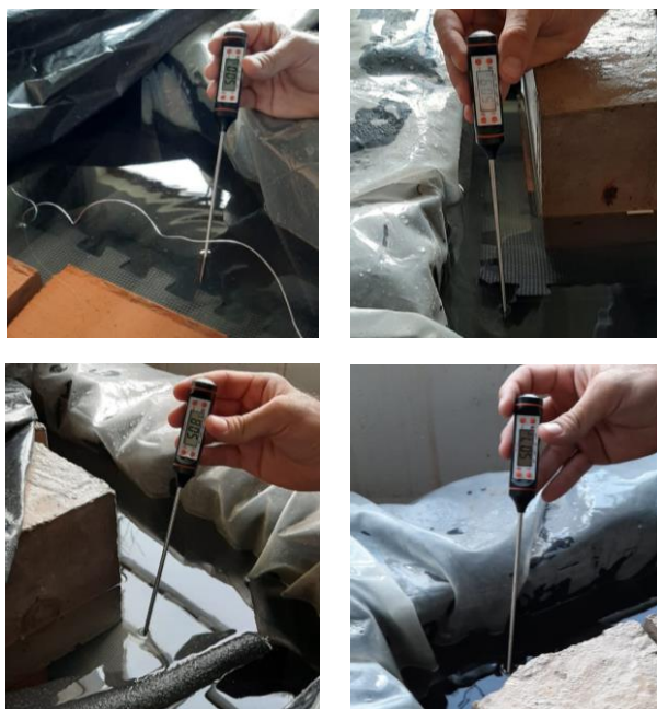
Figura 13. Medição da temperatura da água com termômetro digital em variados pontos do tanque. Fonte: Mazzú, 2020.
