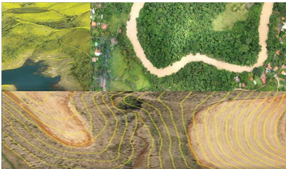
Figura 8. Levantamentos topográficos realizados por VANT. Fonte: HC2 Soluções (2019).
