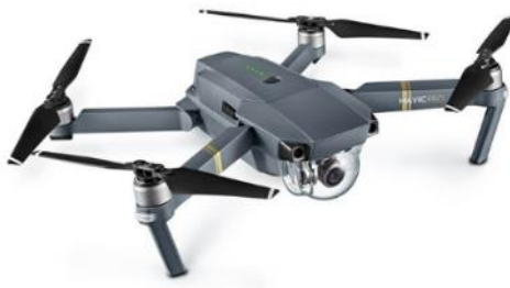
Figura 4. VANT multirotor. Fonte: No ar drones (2023).
