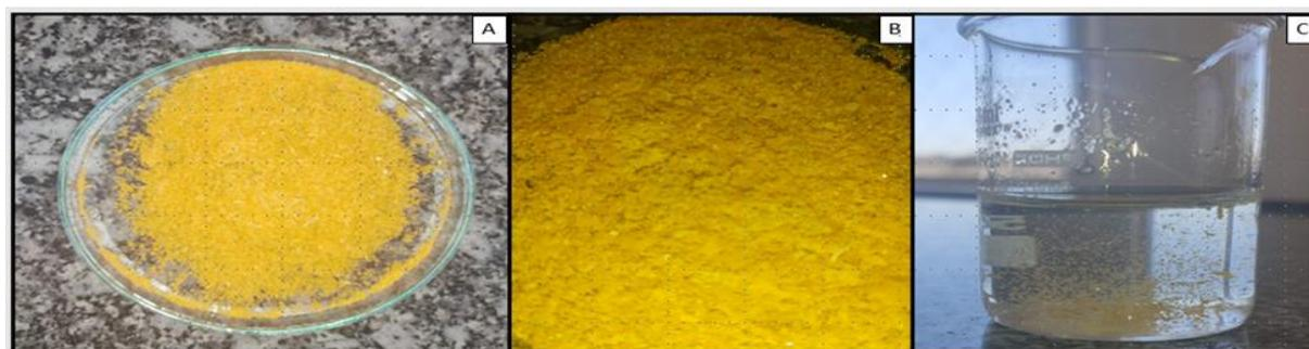
**Figura 4.** Em (A) microplástico à base de leite produzido sem incorporação de glicerina, em (B) microplástico à base de leite e em (C), teste de solubilidade. Fonte: Autores, 2021.
