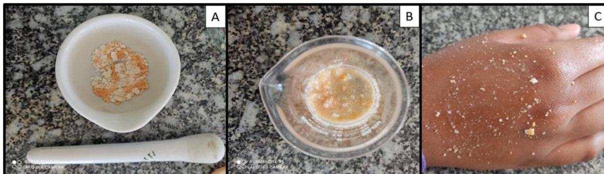
**Figura 3.** Em (A) microplástico à base de leite macerado, em (B) microplástico à base de leite misturado em glicerina e em (C), teste de aplicabilidade, caseira e experimental esfoliante de pele. Fonte: Autores, 2021.
